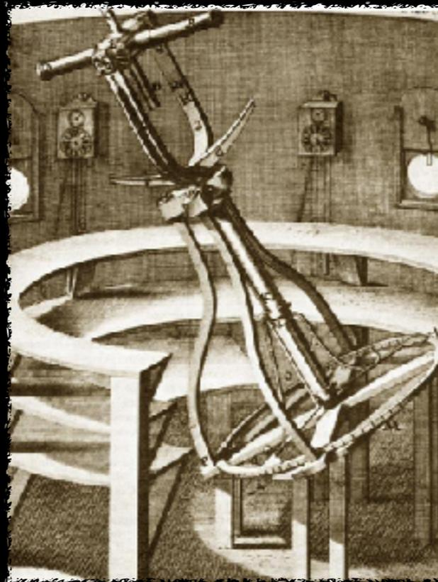
la prima montatura equatoriale per seguire il moto delle stelle
